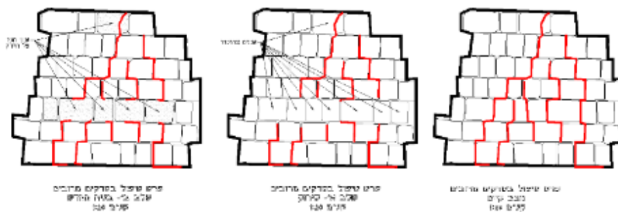
איור 42 - פרט סדק
