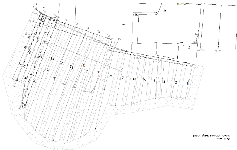
איור 11 - מדידת השטח של קומת הקרקע תוכנית קומת הקרקע של המגדלור ק"מ 1:1000
